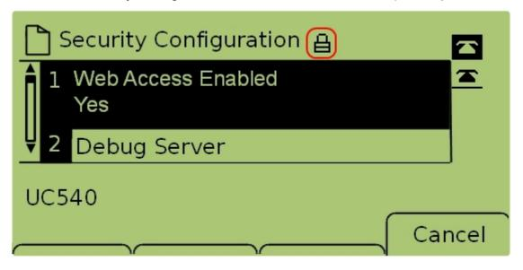
步骤4.如果屏幕顶部有锁定的挂锁,请按键盘上的**星号、星号**、井号以解锁设置,以便编辑设置。
