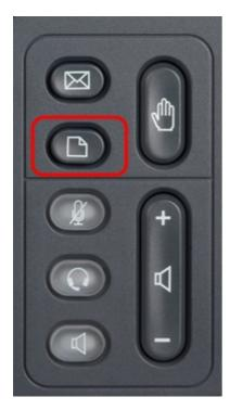
步骤1.按IP电话上的Setup(设置)按钮以打开Setup(设置)菜单。
