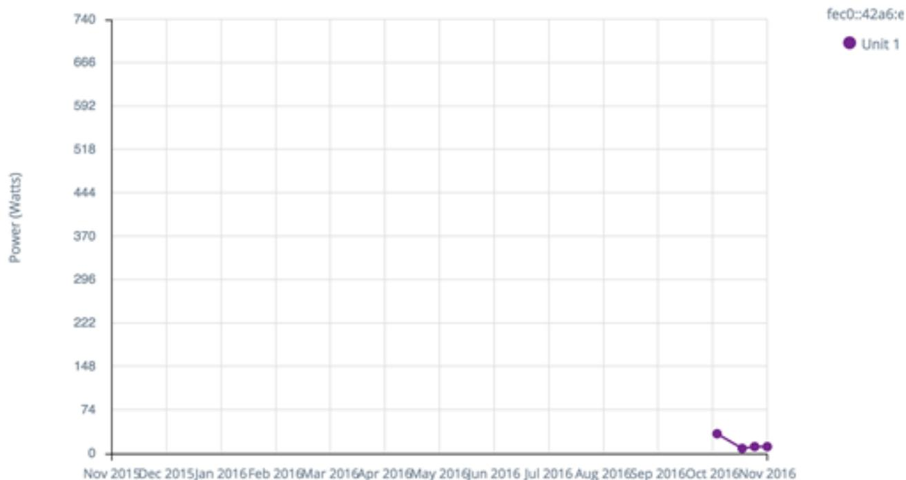
数据显示为瓦数（0是具有最高容量的所选设备的PoE容量），其采样数和频率取决于显示的时间尺度：
