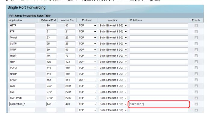
步骤8.选中Enable复选框以启用已配置的规则。
