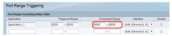
**注意:**端口号的范围可以是1到65535。如前所述,如果对给定范围使用相同的端口号,则可以将流量转发到单个端口。
