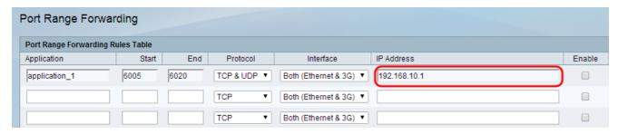
步骤8.选中Enable复选框以启用已配置的规则。
