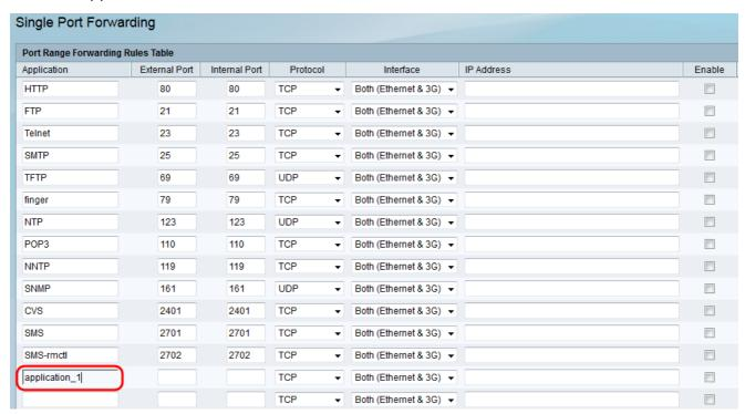
步骤3.在External Port(外部端口)字*段中输入*端口号。外部端口是处理来自互联网的请求的外部端口。Internet用户将使用此端口号连接到应用或服务器。
