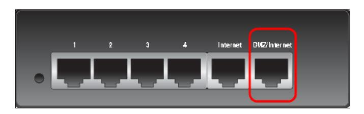
注:要使用辅助ISP,需要从ISP获取第二个IP地址。路由器上的第二个WAN端口或 DMZ/Internet端口可以配置为DMZ端口或辅助ISP端口。辅助WAN端口的默认设置是ISP连接 。要更改此设置,请登录Web配置实用程序并编辑WAN设置。
