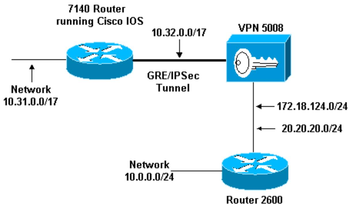
GRE over IPSec 配置在Cisco IOS路由器(7140)和Cisco VPN 5008集中器之间。在这些设备后面，多个网络通过RIP被通告，RIP在7140和VPN 5008之间的GRE隧道内运行。
