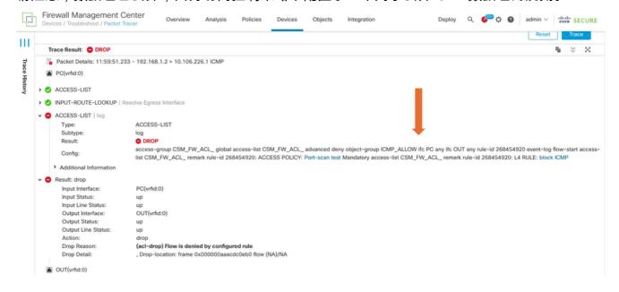
5. 此Packet Tracer使用TCP数据包跟踪的最终结果(如图所示)。
