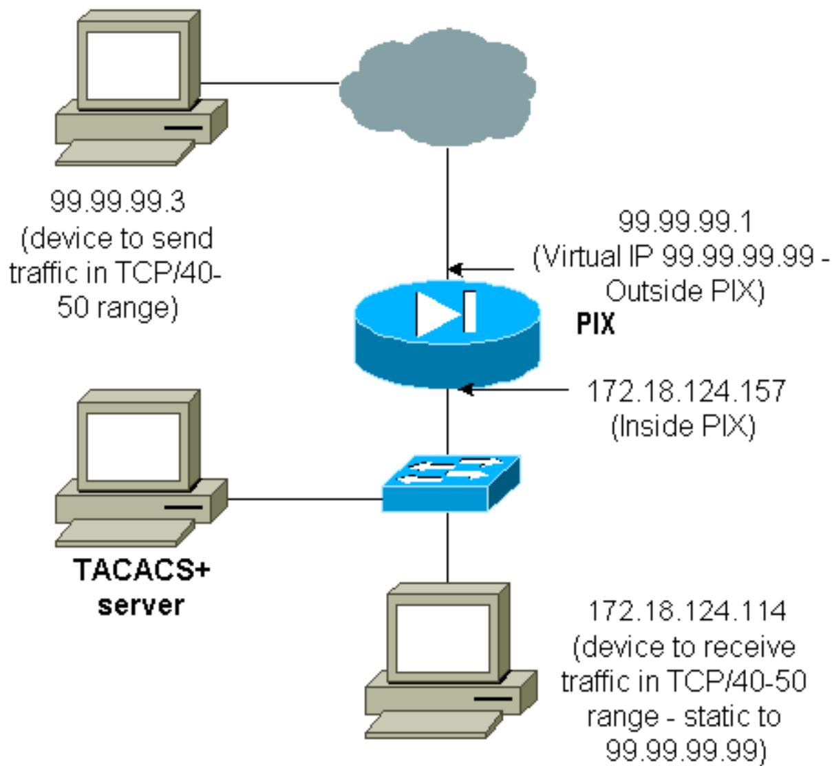
允许对端口范围进行授权。如果在PIX上配置了虚拟Telnet，并且为一系列端口配置了授权，则用户会通过虚拟Telnet打开洞。如果端口范围授权在启动状态，该范围的数据流传输到PIX，PIX则发送命令到TACACS+服务器进行授权。此示例显示端口范围上的入站授权。
