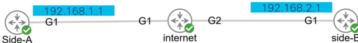
捕获使用扩展访问列表(ACL)，定义要收集的流量类型以及VPN对等体或相关流量段的源地址和目标地址。如果沿路径启用NAT-T，则隧道协商使用UDP端口500和端口4500。一旦协商完成并建立了隧道，如果启用NAT-T，相关流量将使用IP协议50(ESP)或UDP 4500。
