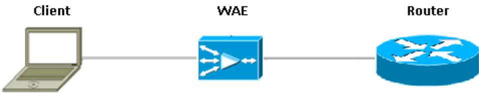
在WAAS设备之间运行Cisco IOS®防火墙的路由器只能看到优化的流量。ZBF功能会监控初始三次握手（TCP选项33和序列号偏移），并自动调整预期的TCP序列窗口（不更改数据包本身的序列号）。它为WAAS优化会话应用完整的L4状态防火墙功能。WAAS透明解决方案可促进防火墙按会话状态防火墙和QoS策略实施。
