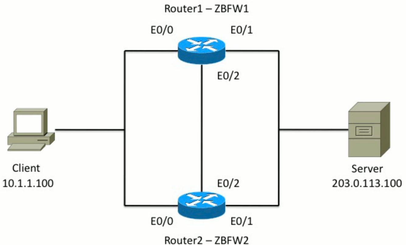
在示例1中所示的配置中，ZBFW配置为从内部到外部检查TCP、UDP和互联网控制消息协议 (ICMP)流量。以粗体显示的配置设置HA功能。在Cisco IOS路由器中，HA通过**redundancy** subconfig命令进行配置。要配置冗余，第一步是在全局检查参数映射中启用冗余。
