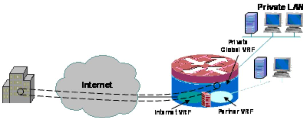
本示例介绍了两个宽带 Internet 连接的配置，此配置对位于公共和合作伙伴 VRF 中的主机访问公共 Internet 应用 PAT (NAT 过载)，并在两个连接上使用 SLA 监视保护 Internet 连接的安全。专用网络（在全局 VRF 中）使用 GRE-over-IPsec 连接维护通过两个宽带链路与总部的连接（包括 VPN 前端路由器的配置）。由于本地隧道端点并未专门附加到某个 Internet 连接，因此在一个或另一个宽带连接失败的情况下，与 VPN 前端的连接将保持畅通，从而可以实现对总部的不间断访问。
