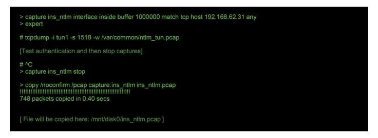
启动两个捕获,相关流量通过Firepower设备运行,然后停止捕获。
