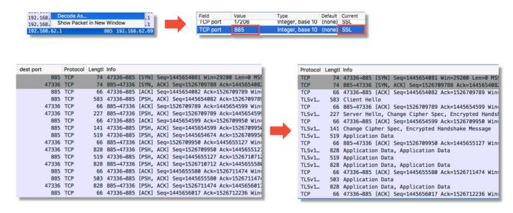
应比较内部接口捕获和隧道接口捕获。在两个PCAP文件中识别相关会话的最佳方法是查找唯一源端口,因为IP地址不同。
