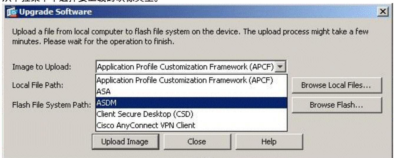
3. 单击 **Browse Local Files...** 或在 **Local File Path** 字段中键入路径，以指定 ASDM 映像计算机上的位置。此时将自动确定和显示 **Flash File System** 中的文件路径。如果未显示 **Flash File System** 中的文件路径，可以手动键入路径，或单击 **Browse Flash**，然后选择路径。
