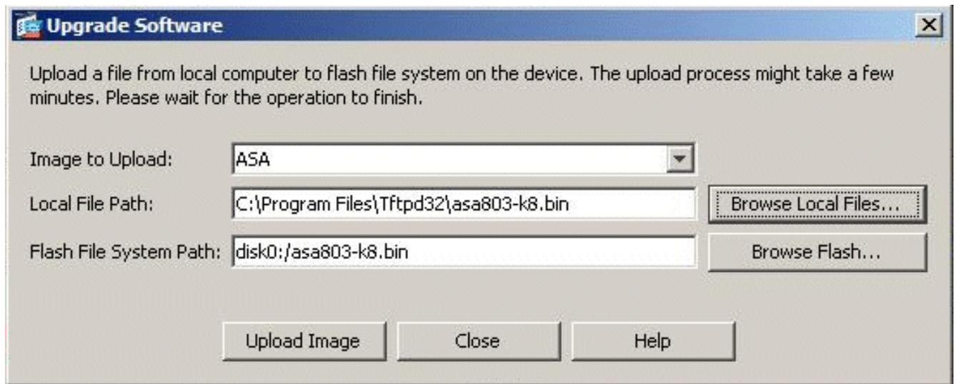
4. 同时指定两个文件路径后，单击 **Upload Image**。ASDM 向闪存写入映像的同时将显示 Status 窗口。
