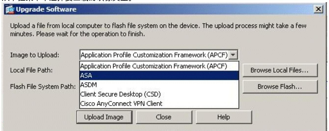
3. 单击 **Browse Local Files...** 或在 **Local File Path** 字段中键入路径，以指定该软件映像计算机上的位置。此时将自动确定和显示 **Flash File System** 中的文件路径。如果未显示 **Flash File System** 中的文件路径，可以手动键入路径，或单击 **Browse Flash**，然后选择路径。
