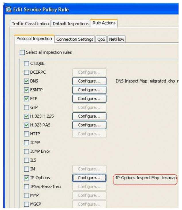
7. 用鼠标将鼠标悬停在Rule Actions选项卡上,以便找到与此全局映射关联的所有可用协议检测映射。
