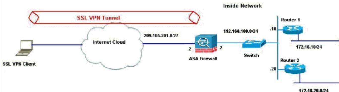
在本示例中，SSL VPN客户端通过隧道访问ASA的内部网络。为内部网络以外的目的地传输的流量也通过隧道传输，因为没有配置拆分隧道，并通过TDG(192.168.100.20)进行路由。
