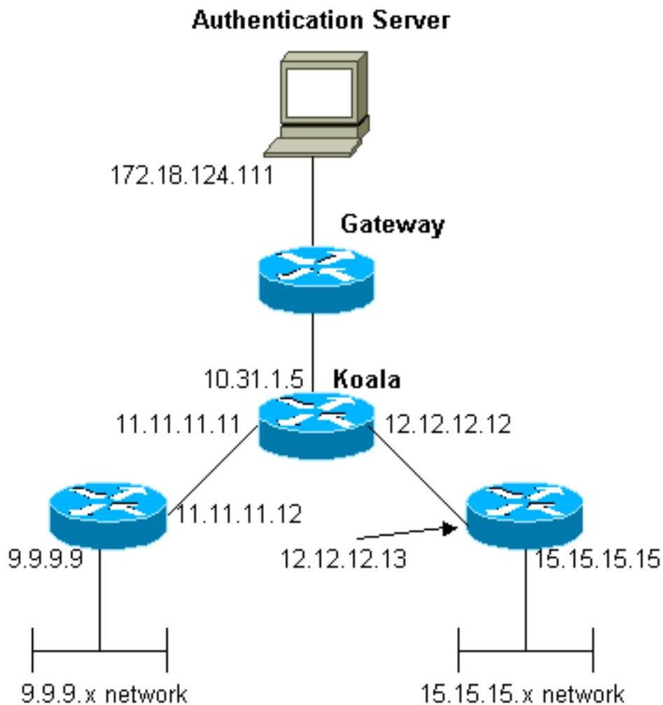
**注意：**配置允许从“mypool”接收地址1.1.1.x的用户对网络9.9.9.x和Telnet ( TCP流量 ) 15.15.15.x执行ping操作。它不允许用户对网络15.15.15.x执行ping操作或通过Telnet访问网络9.9.9.x。
