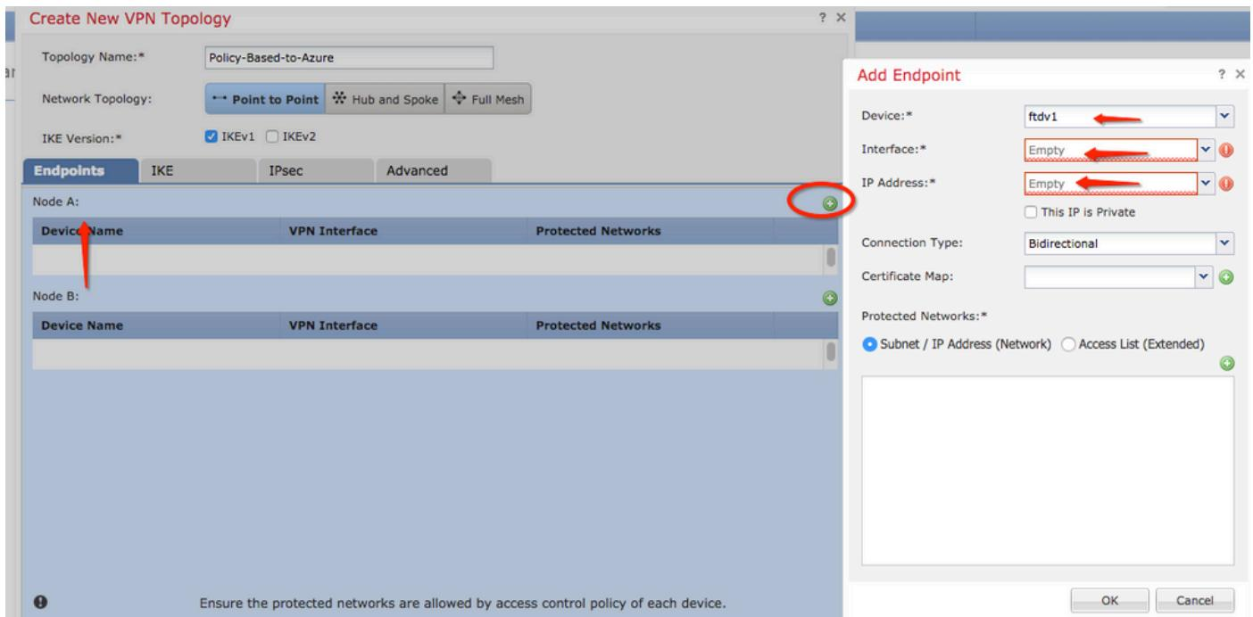
步骤10. 在 Add Endpoint 窗口中，指定要在上使用的FTD Device 下拉列表及其要使用的物理接口和IP地址。
