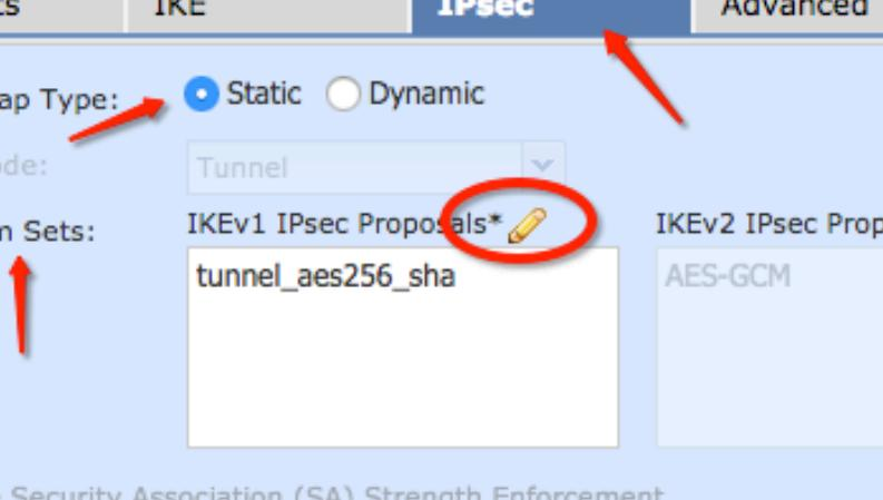
步骤6. 创建新的IPsec提议。在 IKEv1 IPsec Proposal 窗口中，单击 green plus button 添加一个新地址。为 ESP 加密和 ESP 散列算法指定策略名称及其所需参数，然后单击 Save .
