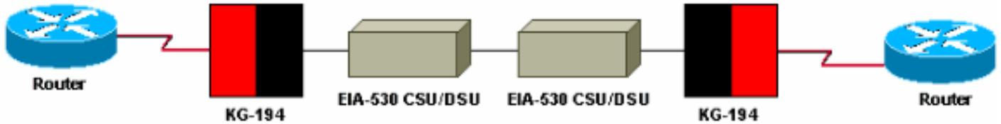
DTR控制信号用于重新同步，或在同步丢失后“准备”加密单元。必须在串行接口配置中输入**pulse-time x**命令，否则加密设备无法知道路由器收到的数据已损坏。
