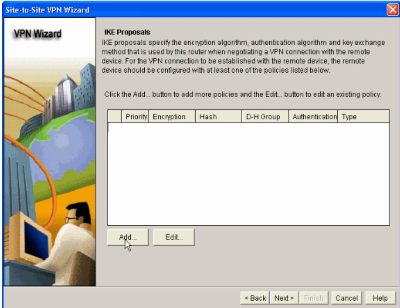
8. 提供加密算法、验证算法和密钥交换方法（如图所示），然后单击 OK。加密算法、验证算法和密钥交换方法值应与 ASA 中提供的数据匹配。
