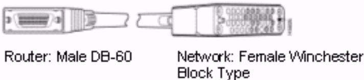
CAB-V35FC 串行电缆用于 Cisco 7000 系列、Cisco 4000 系列、Cisco 3600 系列、Cisco 2500 系列、Cisco 1600 系列、Cisco 接入服务器和 AccessPro PC 卡。此电缆在 Cisco 设备端采用凸头 DB-60 连接器 , 在网络端采用凹头 Winchester 连接器。
