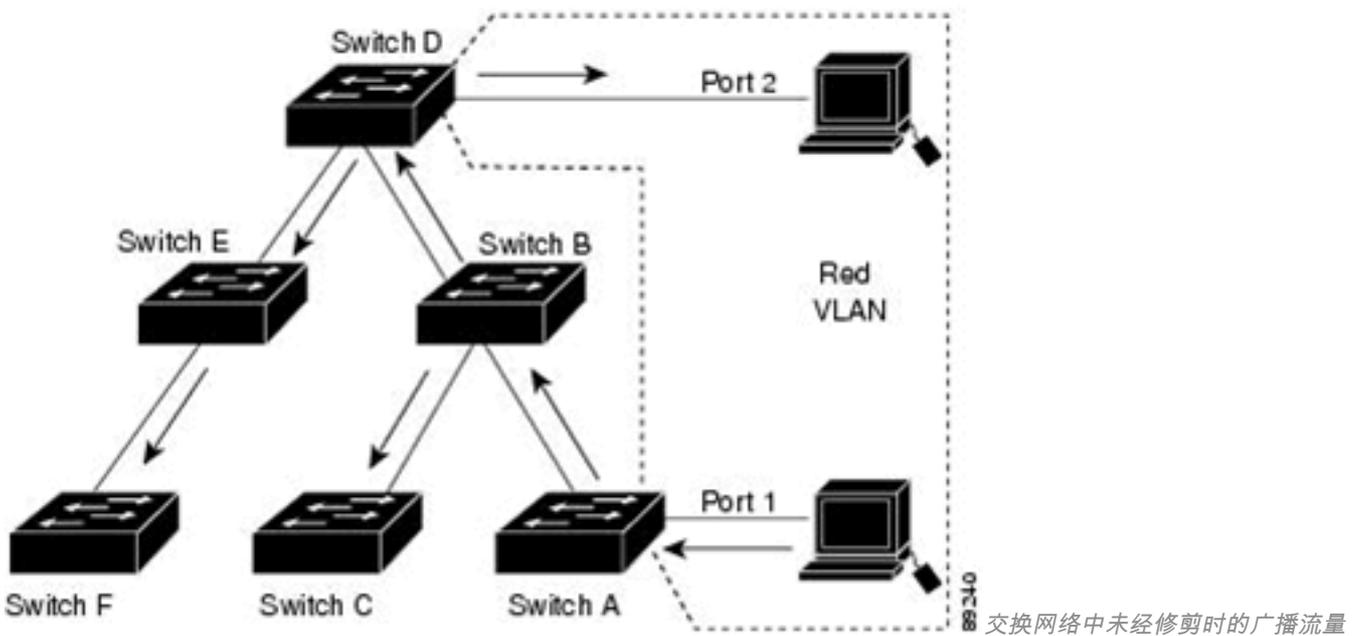
此图显示一个未启用 VTP 修剪功能的交换网络。交换机 A 上的端口 1 和交换机 D 上的端口 2 分配到 Red VLAN。如果从连接至交换机 A 的主机发送广播，则交换机 A 将发生广播泛洪，网络中的每台交换机都会收到该广播，即使是在 Red VLAN 中没有端口的交换机 C、E 和 F 也会收到。
