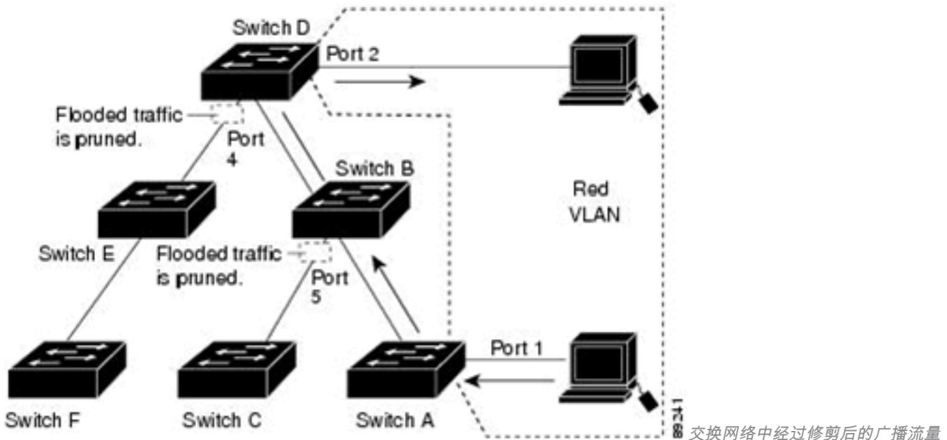
此图显示启用 VTP 修剪功能的同一个交换网络。由于已在所示链路（交换机 B 上的端口 5 和交换机 D 上的端口 4）上修剪了 Red VLAN 的流量，因此不会将来自交换机 A 的广播流量转发至交换机 C、E 和 F。
