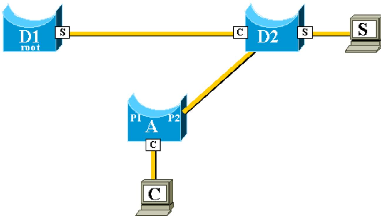
但是，备用链路接通的速度如此之快，以至于 CAM 表不再准确。如果 S 将数据包发送到 C，该数据包会转发到 D1，然后在 D1 中被丢弃。只要 CAM 表不正确，S 和 C 之间的通信就会中断。即使采用[拓扑更改机制](#)，也可能需要长达 15 秒的时间才能解决问题。
