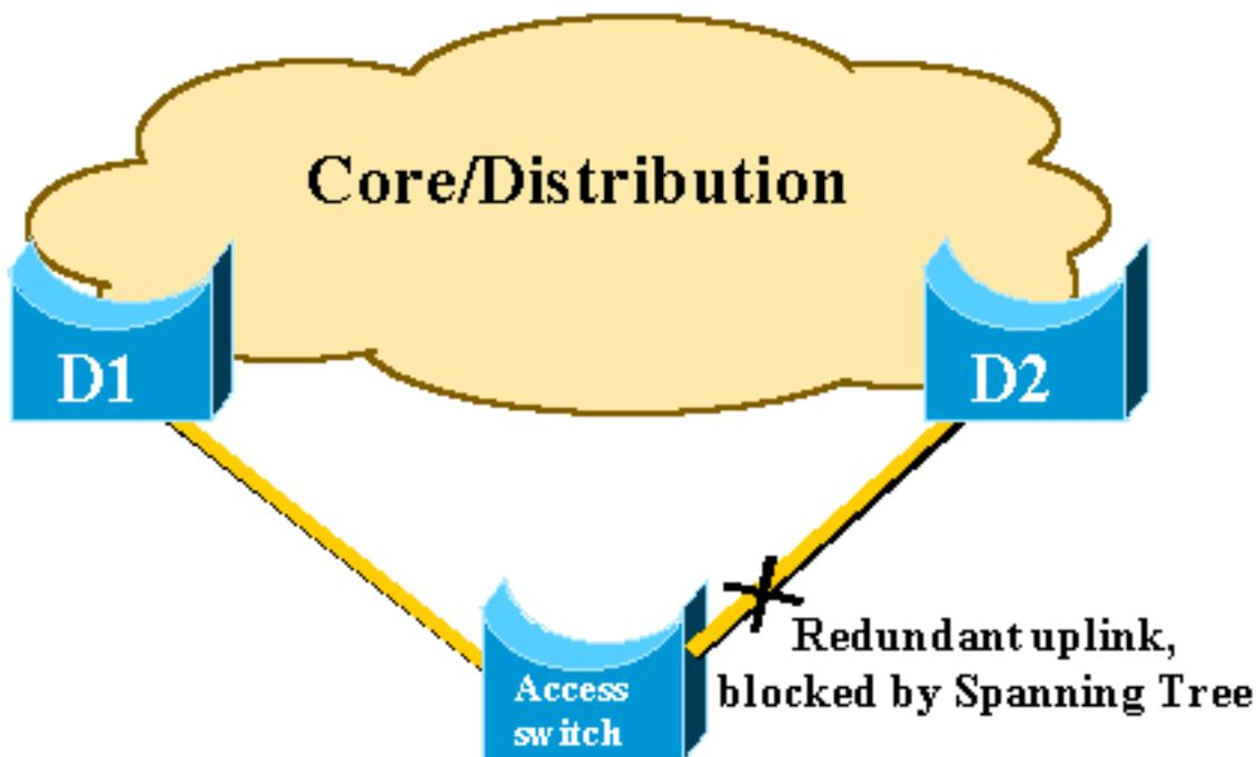
如果通向核心交换机 D1 的主上行链路发生故障，STP 将重新计算并最终将通向交换机 D2 的第二个上行链路取消阻塞，从而恢复连接。使用默认的 STP 参数，恢复连接最多花费 30 秒的时间；通过主动计时器调整，可将此用时缩短到 14 秒。UplinkFast 功能是 Cisco 的专利技术，可将恢复时间进一步减少到秒级。
