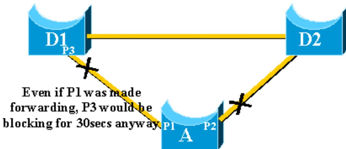
在这种情况下，立即阻塞端口 P2 并将端口 P1 转换为转发状态没有益处。端口 P3 在经过侦听和识别阶段（默认情况下，每个阶段将占用 15 秒）之前不会转发。
