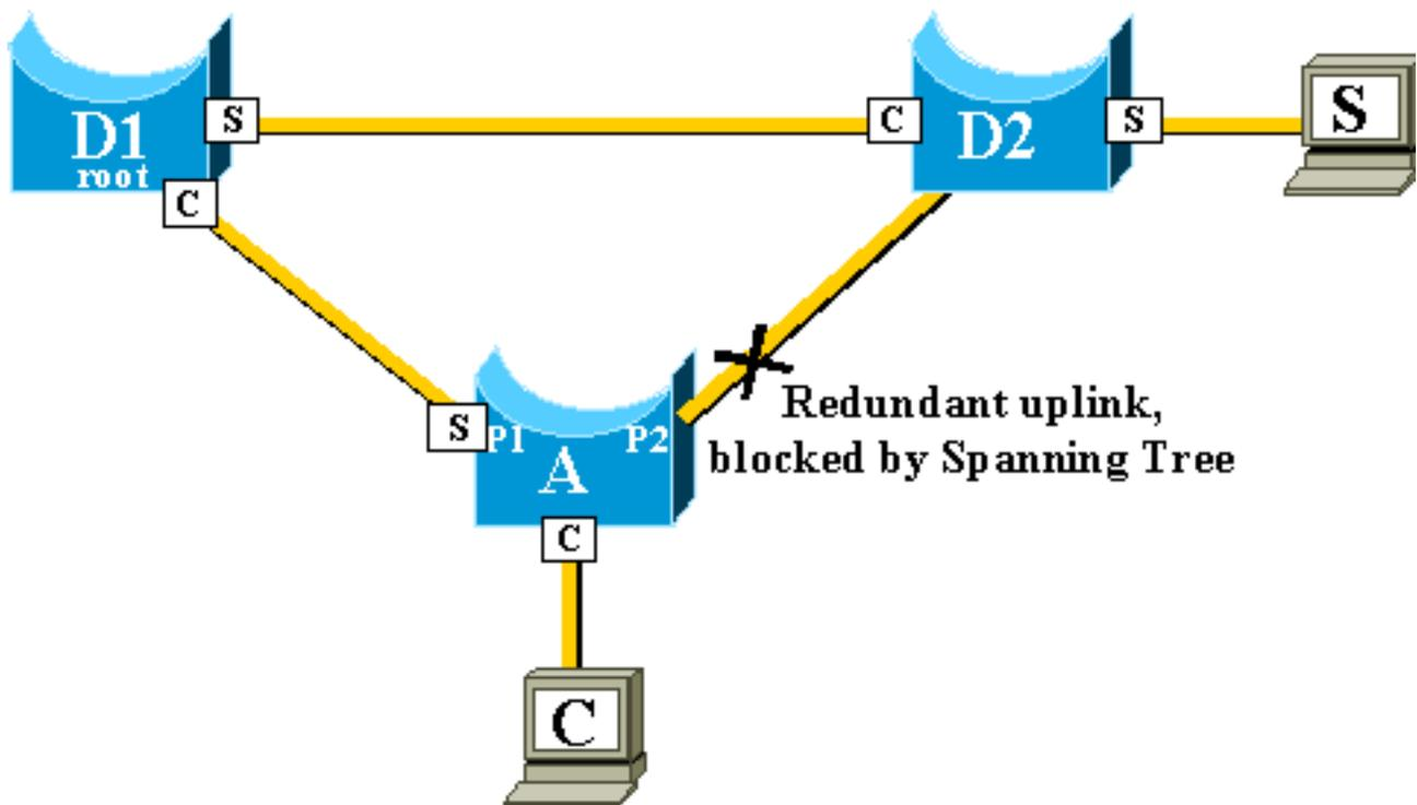
该图中显示了不同交换机的 CAM 表。您可以看到，为了到达 C，源于 S 的数据包必须通过 D2、D1，然后通过 A。
