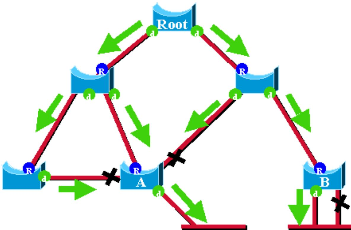
在此图中，根端口用蓝色的 R 表示，指定的端口用绿色的 d 表示。绿色箭头表示由根网桥生成并在它们的指定端口上由网桥重新传输的 BPDU。无需进行正式论证，即可确定关于一个稳定网络中的 BPDU 和端口的以下内容：
