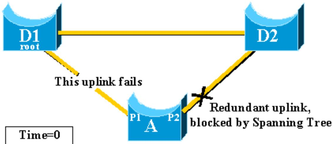
2. 端口 P1 立即断开连接，交换机 A 会将它到 D1 的上行链路声明为已断开。交换机 A 会将它到 D2 的链路（该链路仍从根接收 BPDU）视为替代根端口。网桥 A 可以开始将端口 P2 从阻塞状态转换为转发状态。为了实现这一点，它必须经过侦听和识别阶段。每个这些阶段都将持续 `forward_delay`（默认情况下为 15 秒），并使端口 P2 保持阻塞状态 30 秒。
