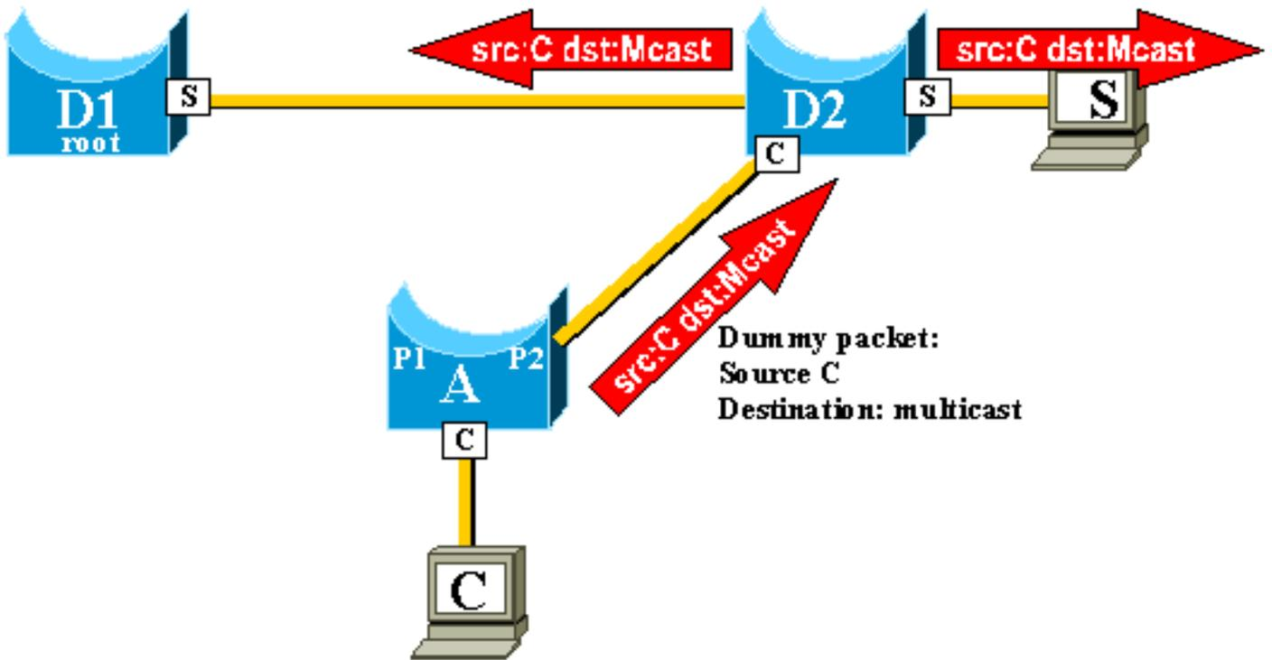
可以对虚拟多播的发送速率进行配置。
