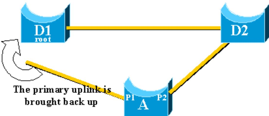
不需要。由于以下原因，不需要立即切换到端口 P1，该端口会立即阻止端口 P2 并将端口 P1 置于转发模式：
