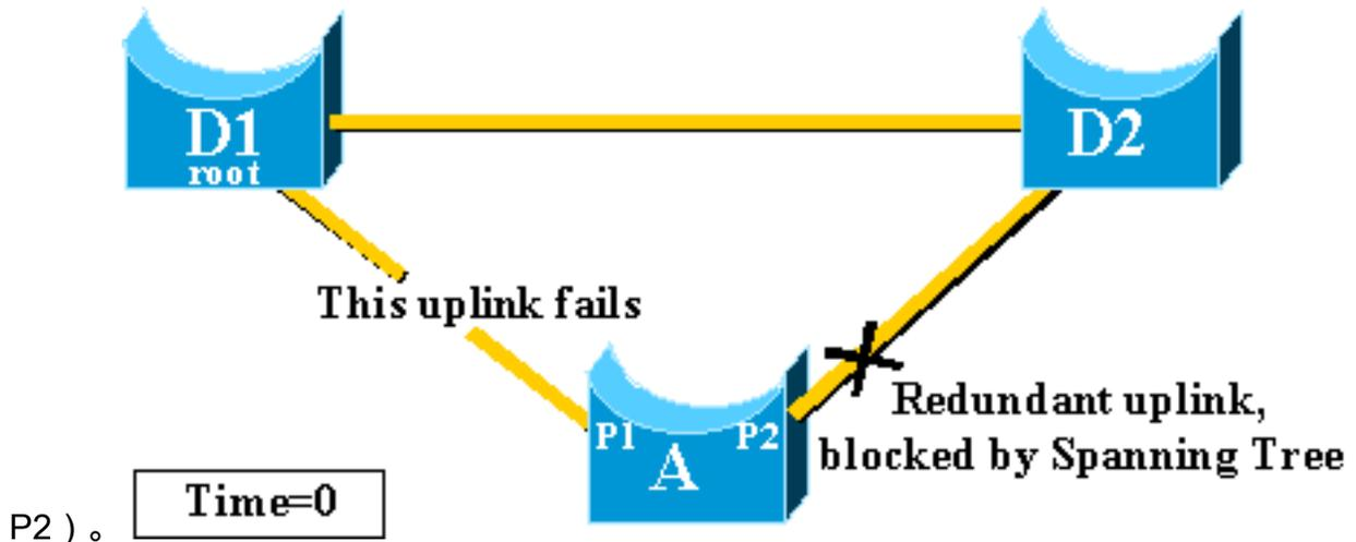
3. A 立即将端口 P2 置于转发模式，因此违反了标准的 STP 过程。网络中没有环路，因为通向根网桥的唯一路径当前已断开。因此，恢复几乎是即时的。
