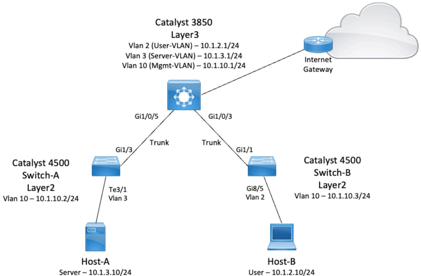
在此图中，Catalyst 3850的小型示例网络提供了各个网段之间的VLAN间路由。Catalyst 3850交换机可用作禁用IP路由的L2设备。要使交换机用作L3设备并提供VLAN间路由，请确保全局启用IP路由。
