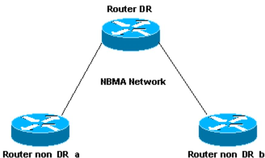
当路由器 non\_DR\_a 计算经过路由器 non\_DR\_b 的路由时，它会使路由器 non\_DR\_b 成为下一跳。但是，路由器 non\_DR\_a 没有通往路由器 non\_DR\_b 的虚电路 (VC)，这意味着这两个路由器无法相互执行 ping 操作。OSPF 会将路由安装到含有无法访问的下一跳的路由表中。
