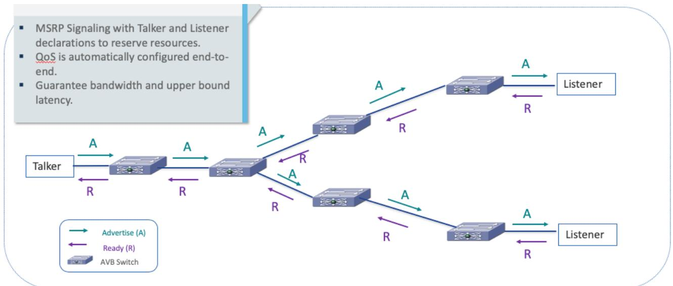
讲话者声明被转发到可能导致保留的目的MAC地址的输出端口。侦听器声明仅传播到具有关联的讲话者声明的端口（即，基于匹配流ID）。如果任何交换机端口上没有注册的关联讲话者声明，则不会传播收听者声明。
