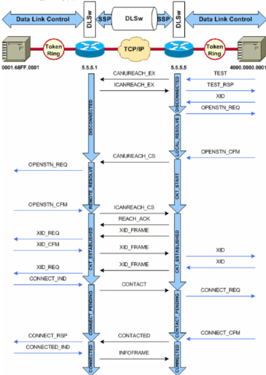
**注意：**电路陷入CKT\_ESTABLISHED状态的最常见原因是非活动主机虚拟电信接入方法(VTAM)交换主节点。
