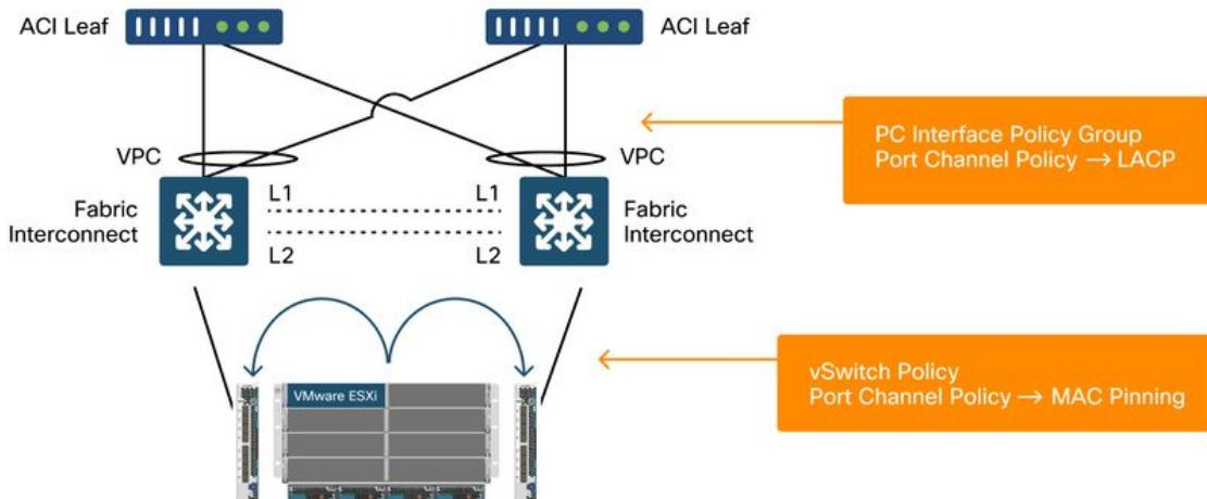
当MAC Pinning作为ACI中的vSwitch策略的一部分在端口通道策略上配置时，将显示为VDS上端口组的“基于源虚拟端口的路由”分组配置。
