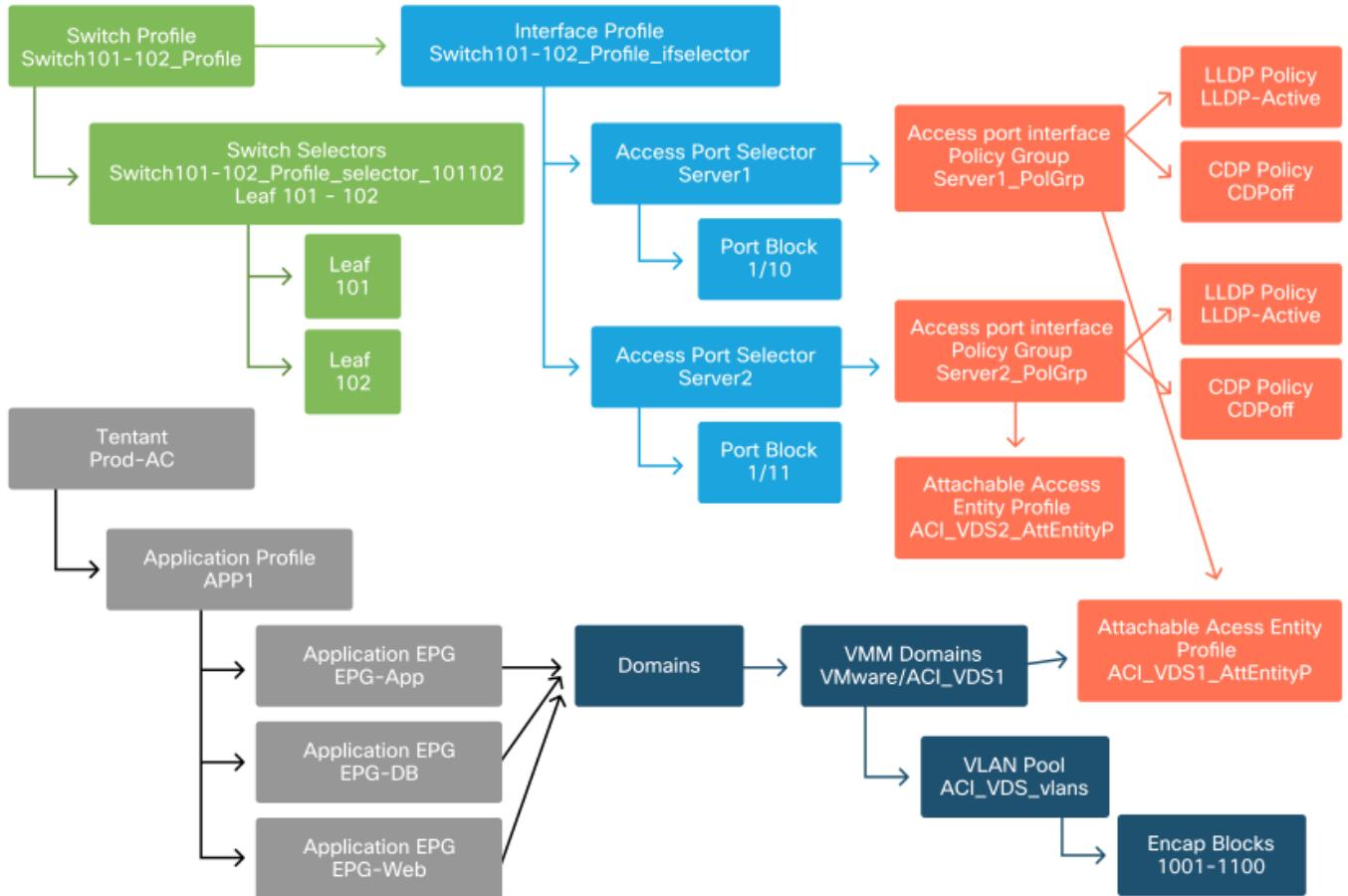
如果为ACI\_VDS1 VMM域中的EPG设置了预调配，则将在服务器1的链路上部署VLAN，但不在服务器2的链路上部署VLAN，因为服务器2的AEP不包括ACI\_VDS1 VMM域。
