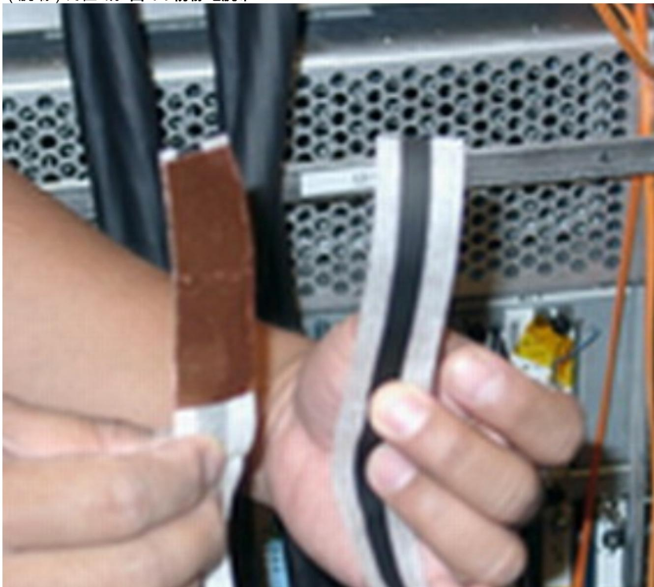
2. 松开手腕端，露出粘合剂。将裸露的金属条（腕端）贴在皮肤上，并将条牢固地缠绕在手腕上以保持紧紧配合(见图2)。图 2：腕带连接到手腕
