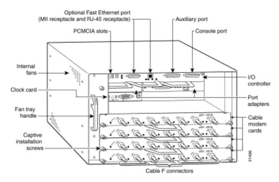
这些路由器基于有线服务数据接口规格(DOCSIS),支持通过双向有线电视和IP主干网络实现数据和数字化语音连接。
