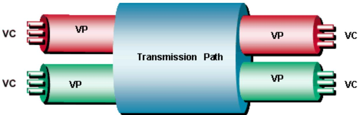
在上图中，到达VC的ATM信元根据信元报头中的VPI和VCI号进行交换。另一方面，到达VP的ATM信元仅基于VPI编号进行交换。ATM交换机的配置确定交换机应分别是特定VPI/VCI对还是VP交换机。
