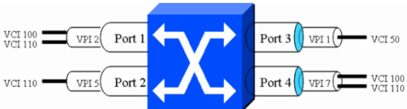
您可以将流量从交换机上即将到来的端口切换到传出端口。例如，您可以确定端口1 VPI/VCI 2/100上的所有流量都切换到端口4 VPI/VCI 7/110。同样，您可以配置ATM交换机以将流量从端口2 VPI/VCI 5/110传输到端口4 VPI/VCI 7/100。此表显示如何将数据包从一个VPI/VCI交换到另一个。这是VC交换，因为它使用VPI和VCI信息来交换流量。
