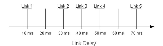
差分延迟是链路清除其警报所花费的累积时间总量。在这种情况下,就会出现 10 毫秒、20 毫秒、30 毫秒、40 毫秒、50 毫秒、60 毫秒和 70 毫秒的累积延迟。差分延迟算法会按链路编号的升序顺序依次检查所有链路以对延迟进行评估。链路1、2、3和4将在组内选择,因为其累积延迟在50毫秒的可容许最大差分延迟内。链路5将从组中拒绝,并进入LODS错误状态。
