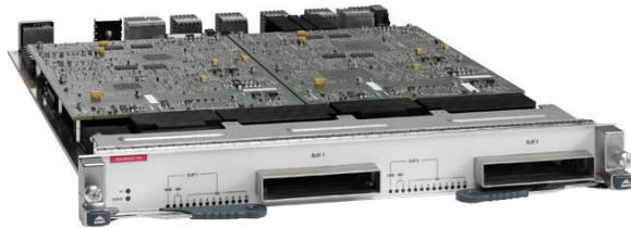
图 1. 带 XL 选项的 Cisco Nexus 7000 M2 系列 2 端口 100 千兆以太网模块
