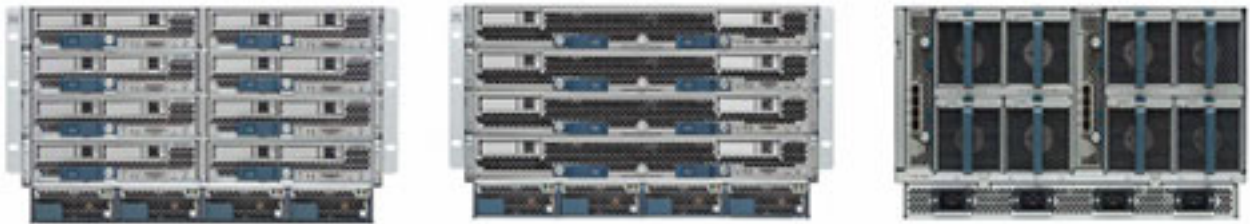
图2. Cisco UCS 5108刀片服务器机箱和刀片服务器的前视图和后视图
