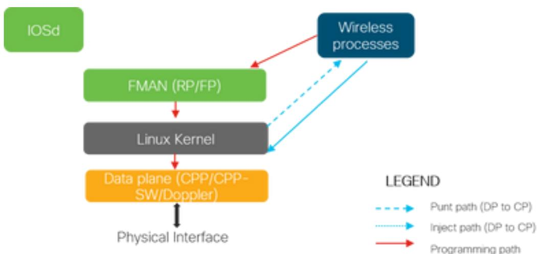
Quando um pacote entra na WLC 9800 a partir de portas físicas, se for determinado que é tráfego de controle, ele é apontado para os Processos do Plano de Controle correspondentes. Para uma junção de AP, isso seria toda a troca de capwap e dtls originada do AP. No caso de ingresso de cliente, esse seria todo o tráfego originado do cliente até que o cliente entre no estado RUN seguiria o caminho PUNT.
