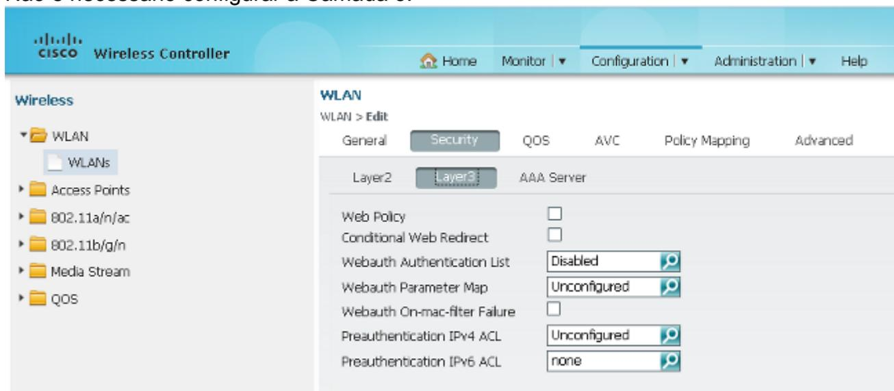
15. Selecione **Security > AAA Server**. Na lista suspensa Método de autenticação, escolha **ISE**. Na lista suspensa Método de contabilização, escolha **ISE**.
