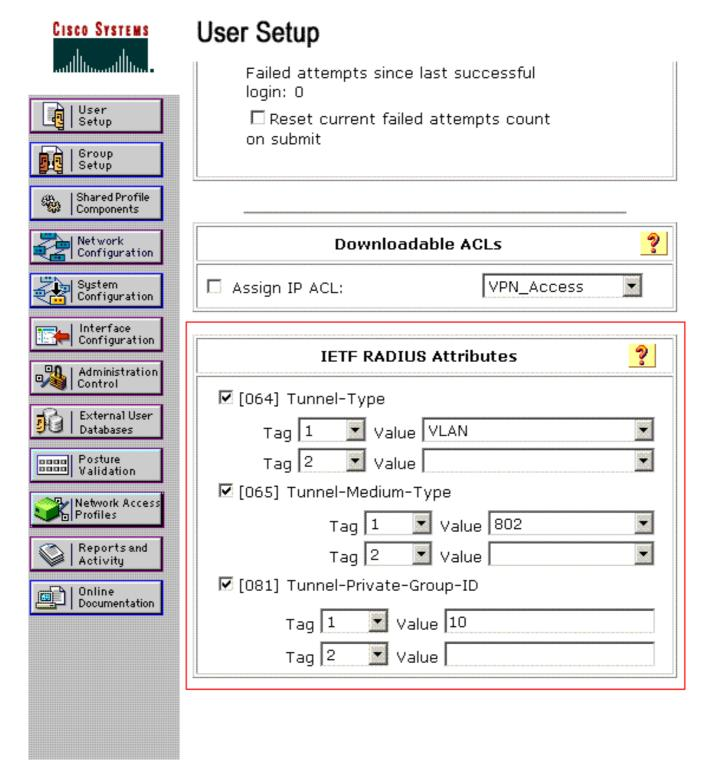
Observação: na configuração inicial do servidor ACS, os atributos RADIUS IETF podem não ser exibidos. Escolha Interface Configuration > RADIUS (IETF) para habilitar os atributos do IETF na janela de configuração do usuário. Depois marque as caixas de seleção dos atributos 64, 65 e 81 nas colunas User e Group.
