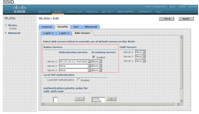
No exemplo fornecido, é função do servidor RADIUS atribuir um cliente wireless a uma VLAN específica para uma autenticação bem-sucedida. As WLANs não precisam estar mapeadas para uma interface dinâmica específica no WLC. Ou, mesmo que o mapeamento da WLAN para a interface dinâmica seja feito no WLC, o servidor RADIUS cancela este mapeamento e atribui o usuário que vem por essa WLAN para a VLAN especificada sob o campo de usuário **Tunnel-Group-Private-ID no servidor RADIUS**.
