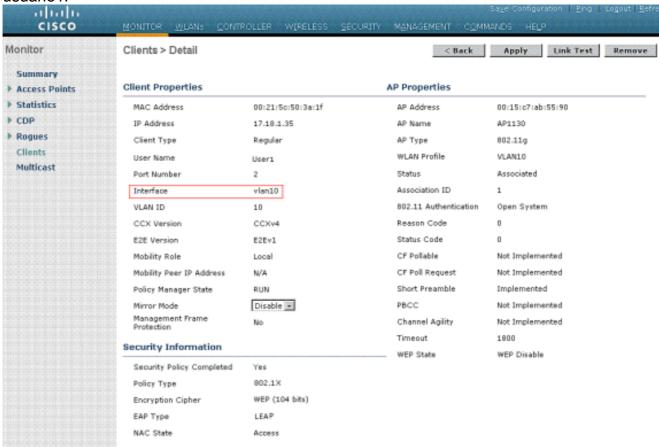
Nesta janela você pode observar que este cliente está atribuído à VLAN10 conforme os atributos RADIUS configurados no servidor RADIUS. Observação: se a atribuição de VLAN dinâmica for baseada na configuração Cisco Airespace VSA Attribute, o nome da interface exibirá como admin conforme este exemplo na página de detalhes do cliente.
