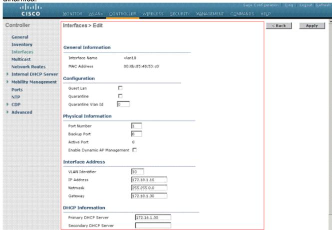
**Observação:** como este documento usa um servidor DHCP interno no controlador, o campo do servidor DHCP primário desta janela aponta para a Interface de Gerenciamento da
