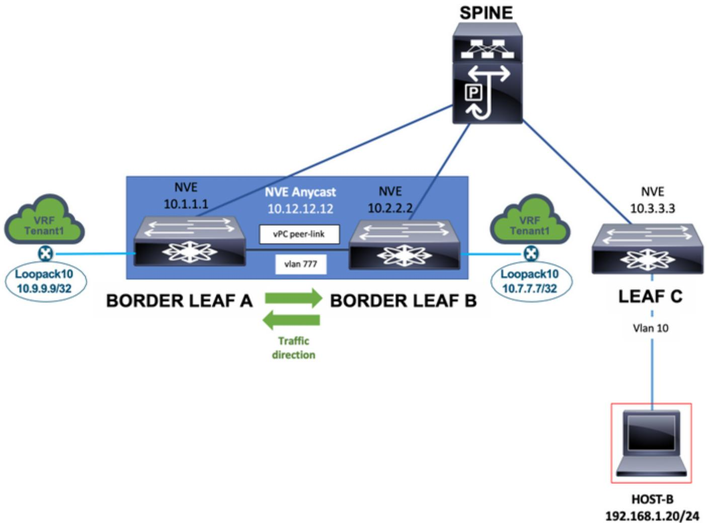
Finalmente, os roteadores externos conectados a switches Border Leaf podem anunciar prefixos de rede que podem ser necessários para ter o link peer do vPC no caminho do tráfego de rede, como visto no próximo diagrama.
