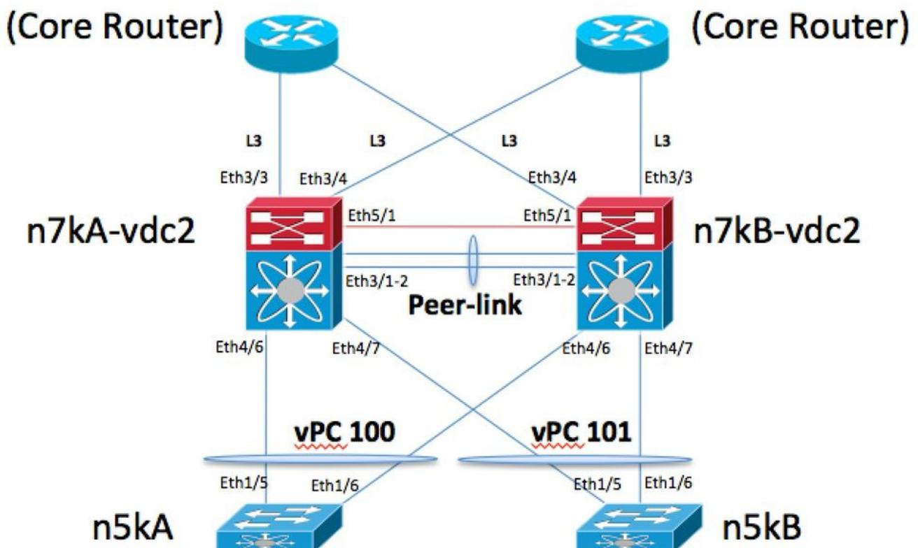
O link do peer do vPC é Port-channel 1. A Ethernet 5/1 é o link peer-keepalive do vPC. Há dois roteadores centrais conectados através de links L3 /30 e3/3 e e3/4 em cada caixa N7K. O N5KA e o N5KB estão simulando os switches L2 vPC conectados no vPC 100 e vPC 101. N7KA é o dispositivo principal do vPC.
