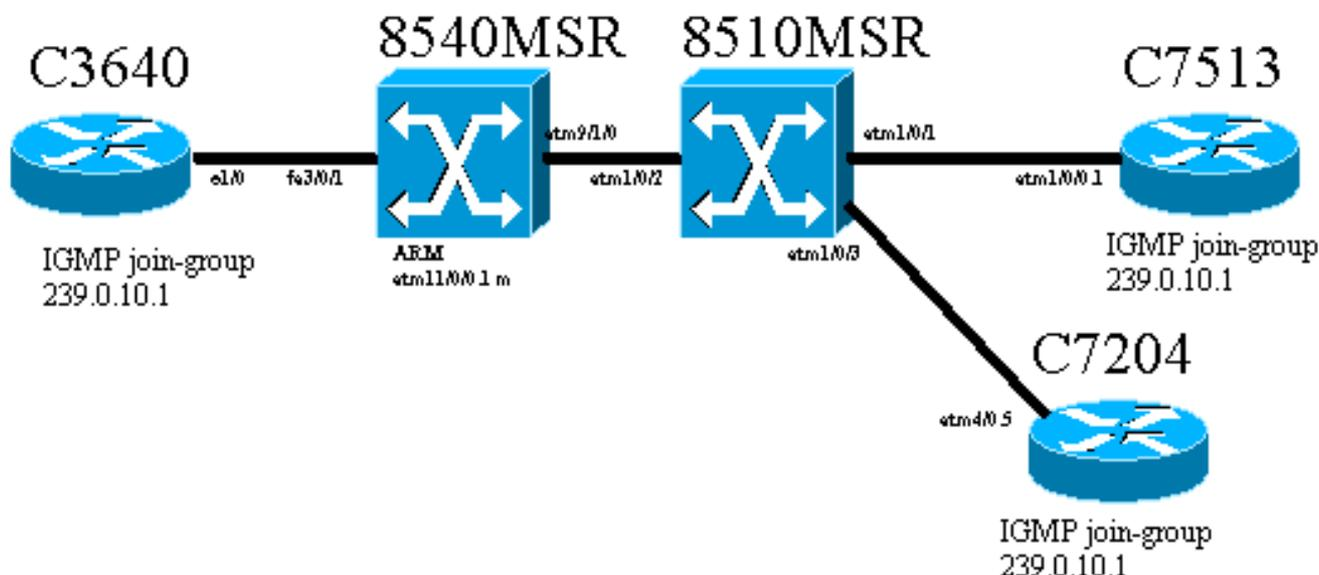
O roteador Cisco 3640, conhecido como C3640, está conectado ao Cisco Catalyst 8540 MSR (conhecido como 8540MSR) através da porta Fast Ethernet 3/0/1. O 8540MSR tem um ARM no slot 11. O C8540MSR está fisicamente conectado ao 8510MSR usando a **interface atm 9/1/0**. The 8510MSR ATM Switch connects to the 8540MSR on ATM interface 1/0/2.
