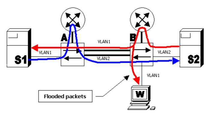
No diagrama acima, o servidor S1 no VLAN 1 está executando o backup (transferência de dados de grande escala) para o servidor S2 no VLAN 2. O servidor S1 tem seu gateway padrão apontando para a interface VLAN 1 do roteador A. O servidor S2 tem seu gateway padrão apontando para a interface VLAN 2 do roteador B. Os pacotes de S1 a S2 seguirão este caminho:
