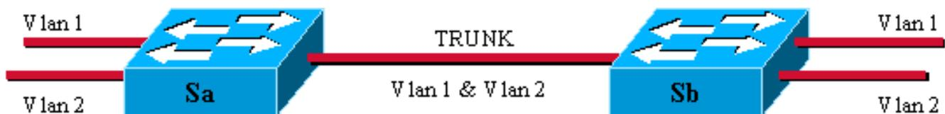
Here, the unique physical link between the two Switches is able to carry traffic for any VLAN. Para conseguir isso, cada quadro enviado no link é marcado por Sa para que Sb conheça a VLAN à qual pertence. Existem diferentes sistemas de marcação. Os segmentos Ethernet mais comuns são:
