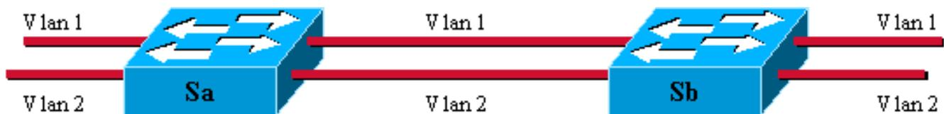
Claro, esta solução não tem escala. Para adicionar uma terceira VLAN, você deve sacrificar duas portas adicionais. Este projeto é também ineficiente em termos de partilha de carga; o tráfego em algumas VLANs pode não justificar um link dedicado. Um tronco agrupa links virtuais em um link físico, como mostrado neste diagrama:
