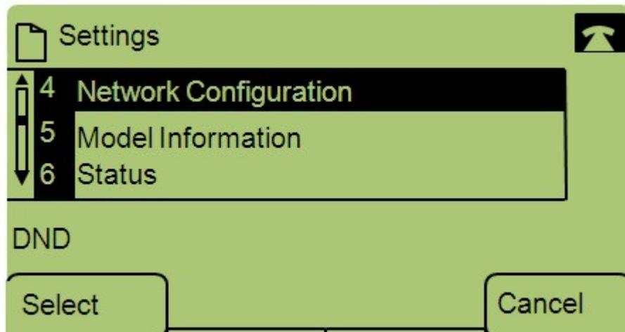
Etapa 3. Navegue até Network Configuration (Configuração de rede) e pressione Select (Selecionar) usando a tecla virtual.
