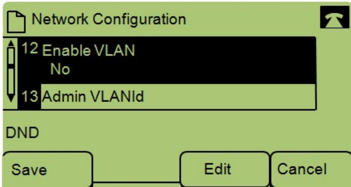
Etapa 4. Navegue para Ativar VLAN — Observação: Pressione \*\*# para desbloquear ou bloquear determinadas opções de edição no telefone.
