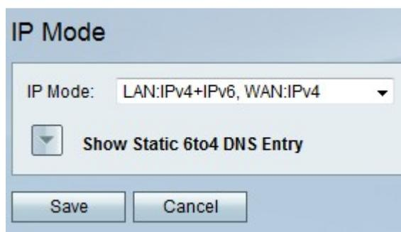
Etapa 2. Na lista suspensa Modo IP, escolha **LAN:IPv6, WAN:IPv4, LAN:IPv6, WAN:IPv6, LAN:IPv4+IPv6, WAN:IPv4** ou **LAN:IPv4+IPv6, WAN:IPv4+IPv6**. Essas opções permitem que o IPv6 seja usado nas interfaces da LAN.
