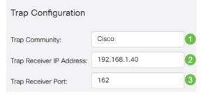
**Note**: Geralmente, o SNMP usa UDP (User Datagram Protocol) como protocolo de transporte e as portas UDP padrão para tráfego SNMP são 161 (SNMP) e 162 (SNMP Trap).
