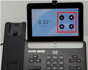
Os dois pontos na parte inferior da tela do LED indicam que há duas páginas. Basta passar o dedo para a esquerda ou para a direita para navegar entre as telas.
