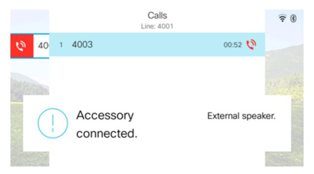
**Note:** Neste exemplo, um fone de ouvido Plantronics VXI X100 V1.1 está conectado à porta USB do Telefone IP Cisco 8861 Multiplataforma. A tecla Fone de ouvido acendeu em âmbar e a chamada é transferida do alto-falante externo para o fone de ouvido.
