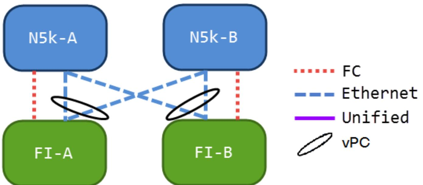
Essa configuração não contém links unificados, mas é a maneira mais fácil de integrar uplinks FCoE ao seu ambiente atual. Essa configuração elimina a necessidade de atravessar as malhas FC.
