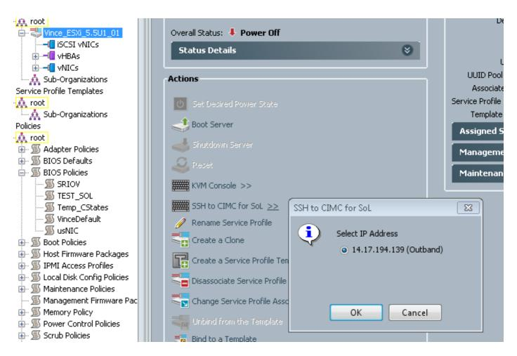
Aqui você pode ver que, fazendo SSH no IP KVM na porta padrão 22, agora você obterá a saída do blade através do túnel de porta serial onboard sobre LAN.
