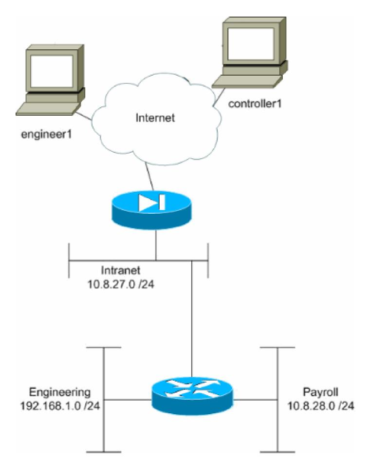
Neste exemplo de configuração, supõe-se uma rede corporativa pequena com três sub-redes. Este diagrama ilustra a topologia. As três sub-redes são Intranet, Engenharia e Folha de Pagamento. O objetivo deste exemplo de configuração é permitir que o pessoal da folha de
