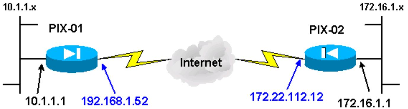
**Observação:** os esquemas de endereçamento IP usados nesta configuração não são legalmente roteáveis na Internet. Esses são endereços [RFC 1918](#) que foram usados em um ambiente de laboratório.
